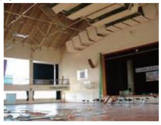
● 天井材が張られている場合は、照明器具周辺の 天井材の破損がないか確認する。
